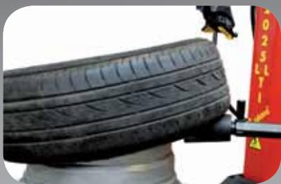
● **ROULEAU CONIQUE.** Il facilite les opérations de démontage et de montage du premier talon, en maintenant celui-ci dans le creux de la jante. ● **RODILLO CÓNICO.** Facilita las operaciones de desmontaje y montaje del primer talón, manteniendo el talón en el canal de la llanta. ● **ROLO CÓNICO.** Facilita as operações de desmontagem e montagem do primeiro talão, mantendo o talão no canal da jante. ● **A** Ajuda na fase de desmontagem do segundo talão.
