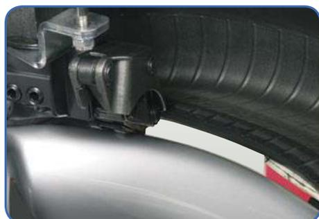
➤ Procedura standard di smontaggio del tallone inferiore con torretta
