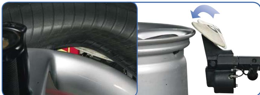
➤ Procedura rapida con disco stallonatore (particolarmente indicata con fianchi duri) per lo smontaggio del tallone inferiore
