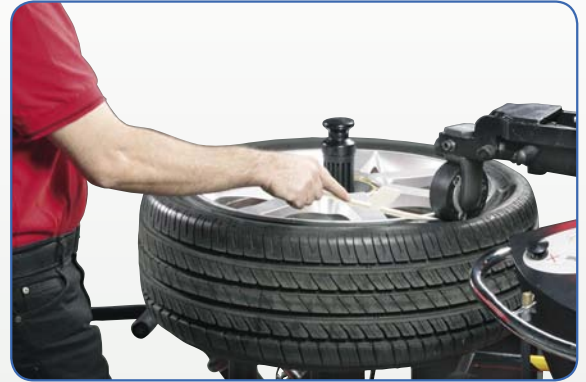
» Inserimento della "reglette" (protezione del cerchio) nel pneumatico PAX Insertion of the "réglette" (rim protection) on PAX tyres
