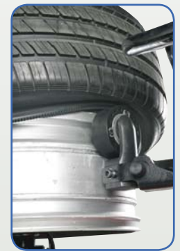
» Stallonatura del tallone inferiore del pneumatico PAX e del suo supporto interno Breaking of bottom bead of PAX tyres and the internal rest
