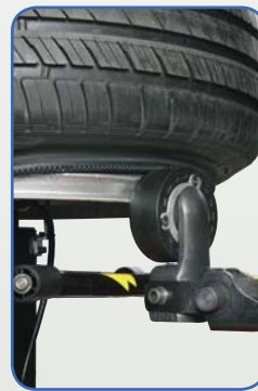
» Stallonatura del tallone inferiore del pneumatico PAX e del suo supporto interno Breaking of bottom bead of PAX tyres and the internal rest
