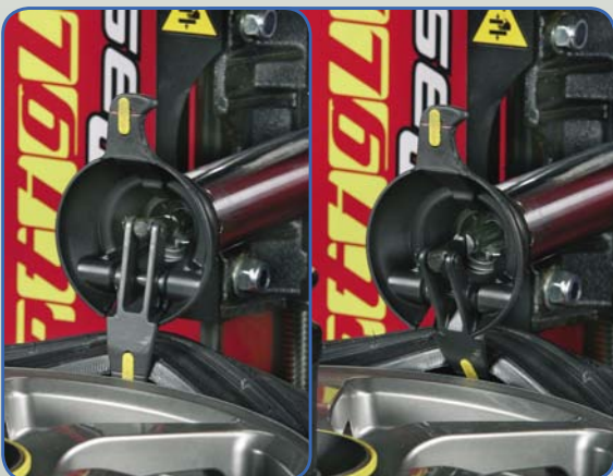
► Smontaggio del tallone superiore. Il movimento d'arretramento in contemporanea dell'utensile e dell'autocentrante che blocca il cerchio, garantisce la corretta tolleranza di lavoro tra i due e riduce la tensione sul tallone del pneumatico. Demounting the top bead. The simultaneous retraction of the tool and the turntable which clamps the rim, ensures the correct working tolerance between the two parts, and minimises the stress on the tyre bead.
