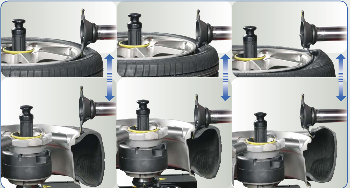
► Ricerca automatica del tallone del pneumatico senza alcun contatto con il cerchio indipendentemente dalla sua forma. Automatic location of the tyre bead, with no contact with the rim itself, regardless of its shape.
