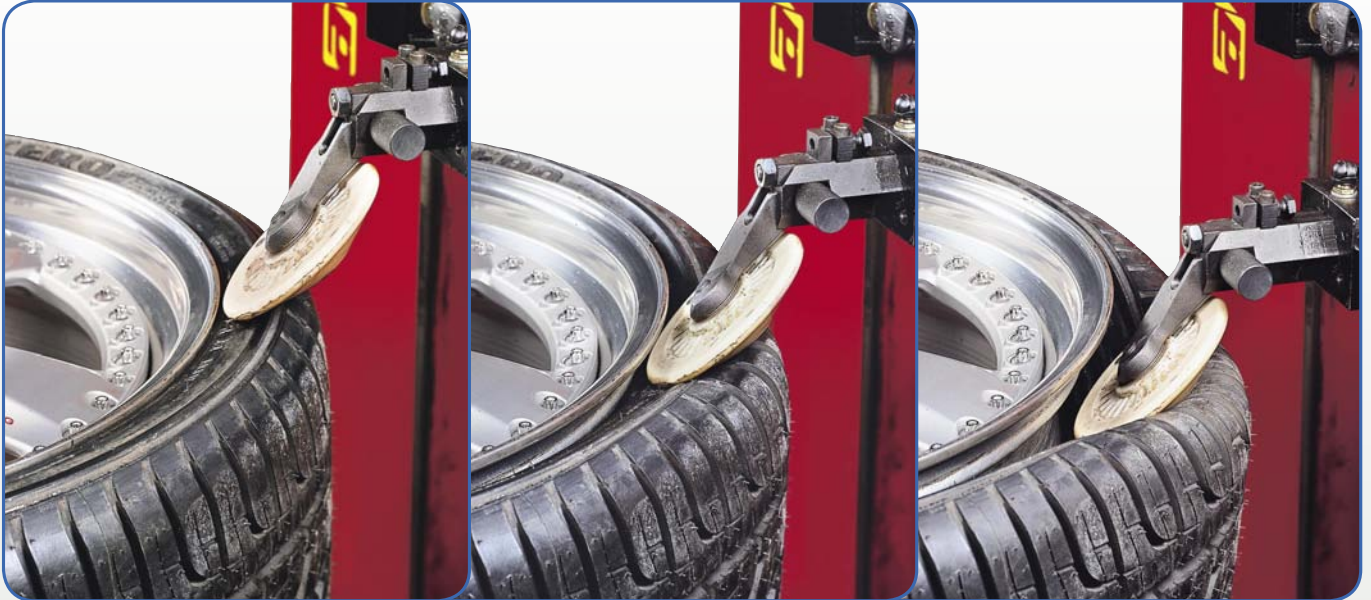
► Movimento di stallonatura a penetrazione controllata Controlled penetration bead breaking movement
