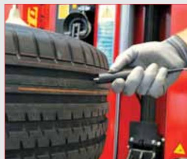
mesure de la profondeur de la bande de roulement
