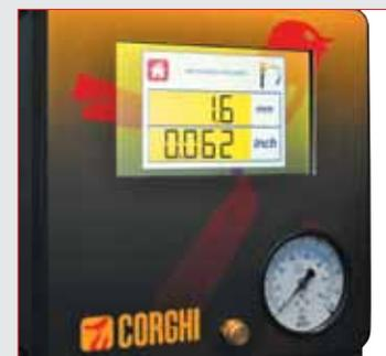
données de la profondeur de la bande de roulement : sur fond jaune proche du seuil limite
