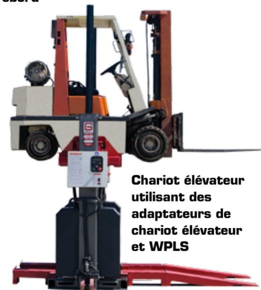
Chariot élévateur utilisant des adaptateurs de chariot élévateur et WPLS
