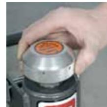
Le bouton de relâchement **Hold-to-Run<sup>MC</sup>** assure un taux de descente plus lent avec un contrôle précis de la part de l'opérateur
