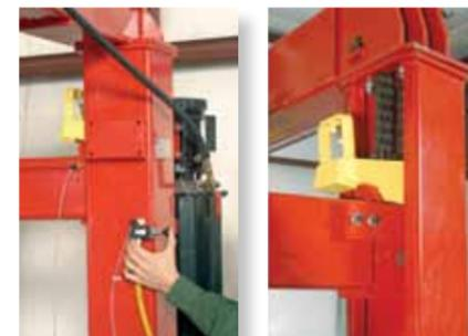
Mécanisme de verrouillage pneumatique à un seul point et déverrouillage simultané depuis un seul emplacement
