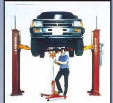
Le système breveté de balancement hydraulique Mohawk élimine la nécessité de plaques de plancher et les obstructions en haut du vérin, vous assurant un espace de travail dégagé et un accès complet sous tout véhicule.
