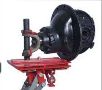
La tête tourne sur 360 degrés, inclinaison avant et arrière, capacité de verrouillage et quatre supports cliquetants rapides réglables
